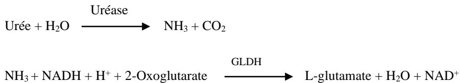
Le taux de variation de la différence d'absorbance entre 340 nm et 405 nm est causé par la conversion de NADH en NAD<sup>+</sup> et est directement proportionnel à la quantité d'urée présente dans l'échantillon.
