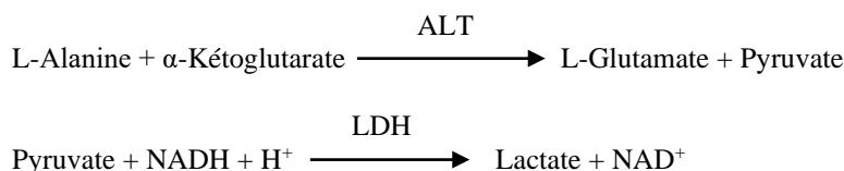
Le taux de variation de l'absorbance entre 340 nm et 405 nm est causé par la conversion de la NADH en NAD<sup>+</sup> et est directement proportionnel à la quantité d'ALT dans l'échantillon.
