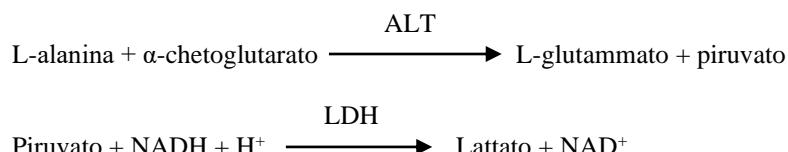
La velocità di variazione della differenza di assorbanza tra 340 nm e 405 nm è dovuta alla conversione di NADH in NAD<sup>+</sup> ed è direttamente proporzionale alla quantità di ALT presente nel campione.
