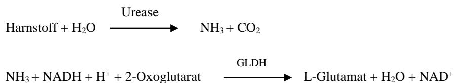
Die Änderungsgeschwindigkeit der Extinktionsdifferenz zwischen 340 nm und 405 nm hängt mit der Umwandlung von NADH zu NAD<sup>+</sup> zusammen und ist direkt proportional zur Menge des in der Probe vorhandenen Harnstoffs.
