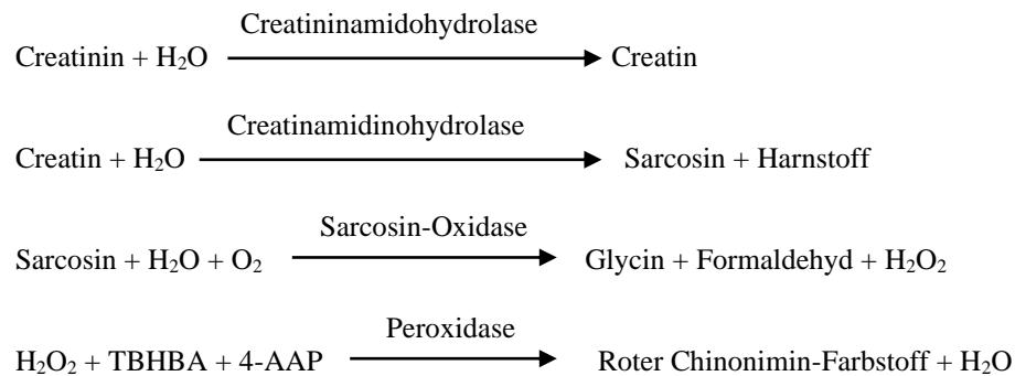
Die Creatinin-Konzentration in der Probe wird mit zwei Küvetten bestimmt. Das endogene Creatin wird in der Blindwertküvette gemessen und von der Gesamtsumme aus endogenem Creatin und durch Enzymreaktionen in der Testküvette gebildetem Creatin subtrahiert. Wenn das endogene Creatin aus den Berechnungen entfernt ist, ist die Creatinin-Konzentration proportional zur Intensität der produzierten roten Farbe. Die Endpunktreaktion wird als die Extinktionsdifferenz zwischen 550 nm und 600 nm gemessen.
