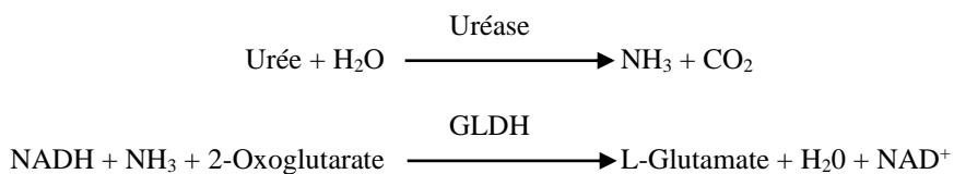
Le taux de variation de la différence d'absorbance entre 340 nm et 405 nm est causé par la conversion du NADH en NAD<sup>+</sup> et est directement proportionnel à la quantité d'urée présente dans l'échantillon.
