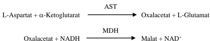
Die durch die Umwandlung von NADH zu NAD<sup>+</sup> bewirkte Extinktionsänderungsgeschwindigkeit (340/405 nm) verhält sich direkt proportional zu der in der Probe vorhandenen AST-Menge.
