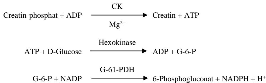
Die Bildung von NADPH wird als Extinktionsänderung bei 340 nm im Verhältnis zu 405 nm bestimmt. Diese Extinktionsänderung verhält sich direkt proportional zur Creatin-Kinase-Aktivität in der Probe.
