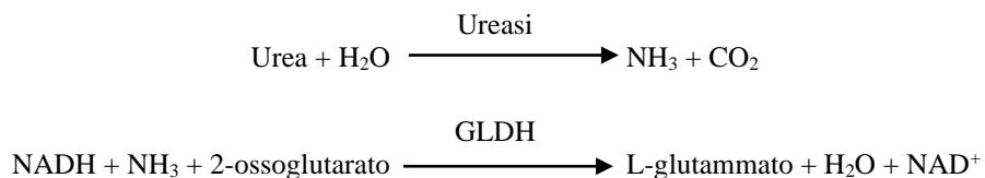
La velocità di variazione della differenza di assorbanza tra 340 nm e 405 nm è causata dalla conversione di NADH in NAD<sup>+</sup> ed è direttamente proporzionale alla quantità di urea presente nel campione.
